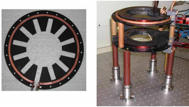
Abb. 4.5: Das linke Bild zeigt die eloxierte Aluminiumscheibe mit der Kühlschleife aus Kupfer. Das rechte Bild zeigt die montierte Anordnung der Spulen mit dem Helmholtz Spulenpaar und den vier Spulen zur Erzeugung des Gradientenfeldes.
