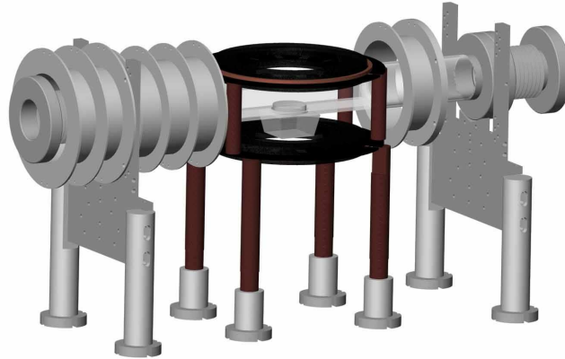
Abb. 4.7: Die Abbildung zeigt die Anordnung der Magnetspulen für den Zeeman-Abbremsers. Die Spulenummer wurde von links nach rechts vergeben.
