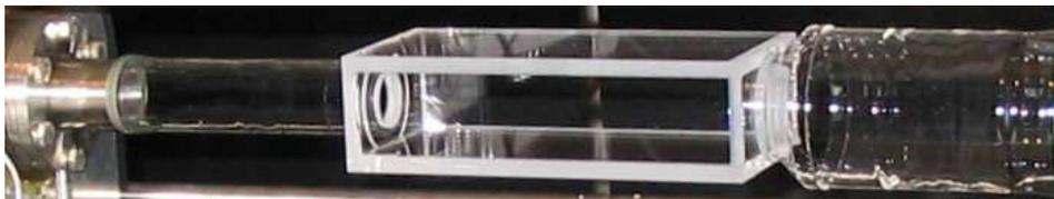
**Abb. 3.3:** Die Glaszelle, ein 170 cm×78 cm×48 cm großen Quader bietet optimalen optischen Zugang. Zwei Glass-Metallübergangsröhre mit den Innendurchmessern  $d_1=28$  mm und  $d_2=58$  mm verbinden sie mit den Metallflanschen. Die vier Seitenflächen haben eine Stärke von 6,5 mm und die zwei Stirnflächen eine Stärke von 5 mm.
