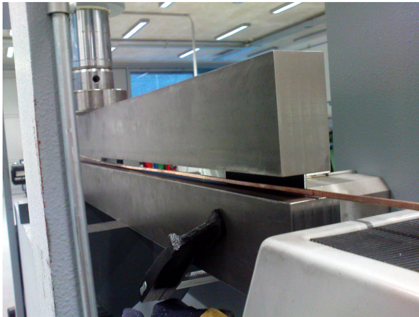
Abbildung C.1: Photographie der Presse zur Ausrichtung der Kupferrohre.
